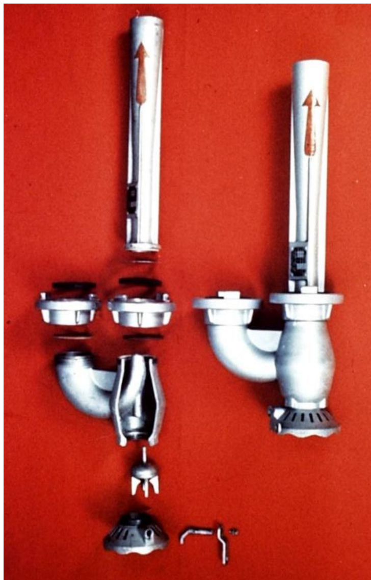
Obr. č. 8. Součásti stojatého ejektoru.
