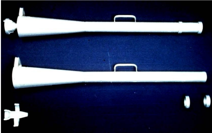
Obr. č. 28. Pěnotvorná proudnice na těžkou pěnu.
