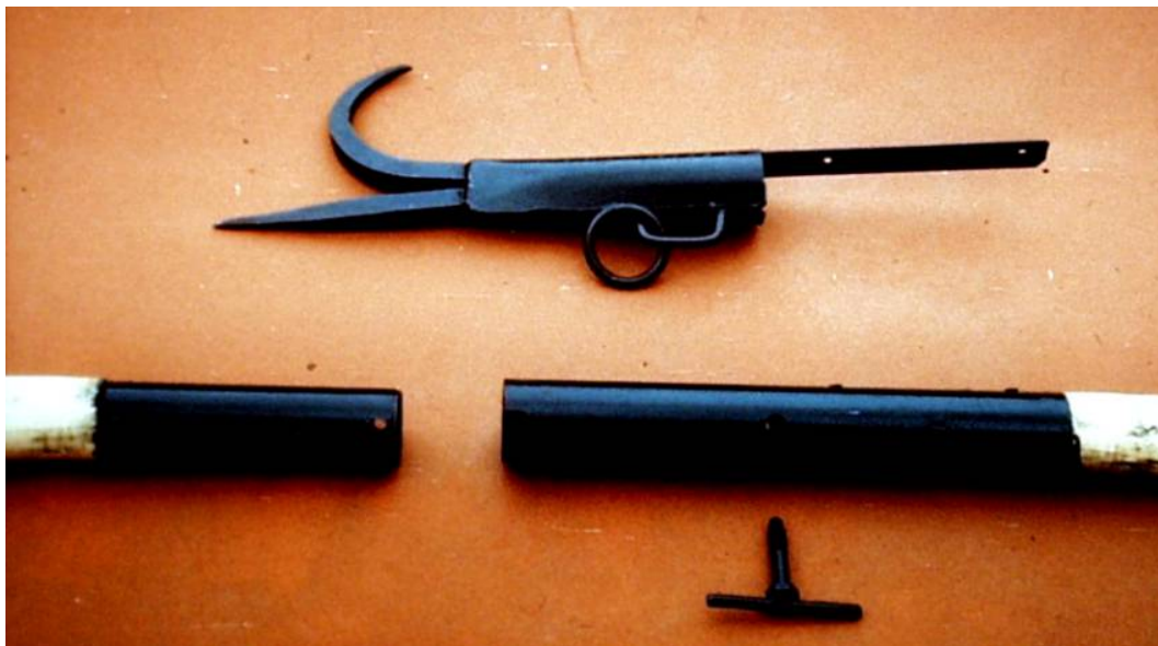
Obr. č. 38. Detail háku a spojení tyče.
